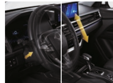
Lenksäule in der Tiefe und der Höhe verstellbar
