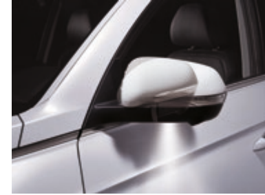
Elektrisch anklappbare Außenspiegel mit integrierter Umfeldbeleuchtung
