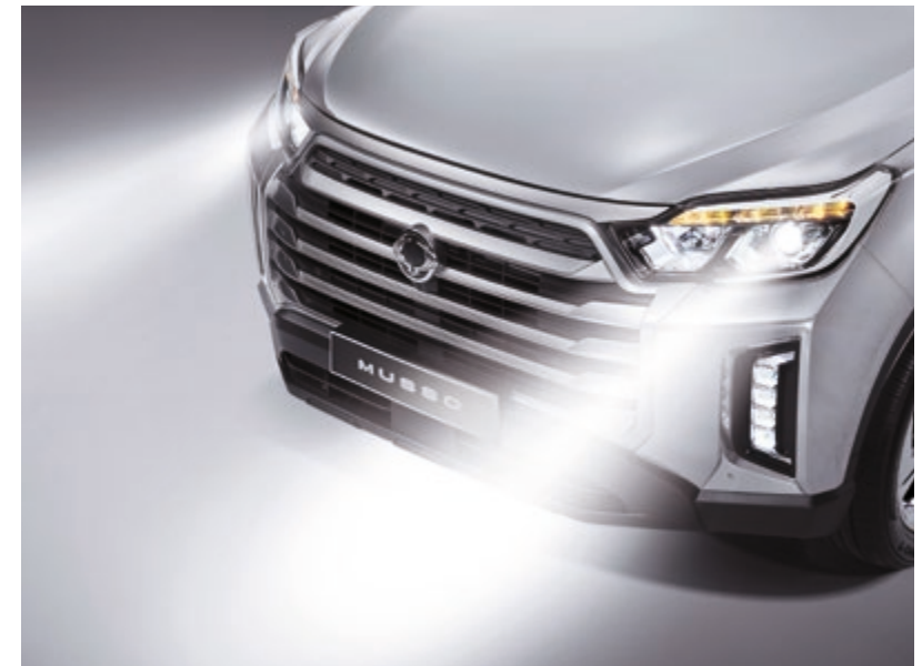
LED-Nebelscheinwerfer und HID-Scheinwerfer mit Coming-Home-Funktion
